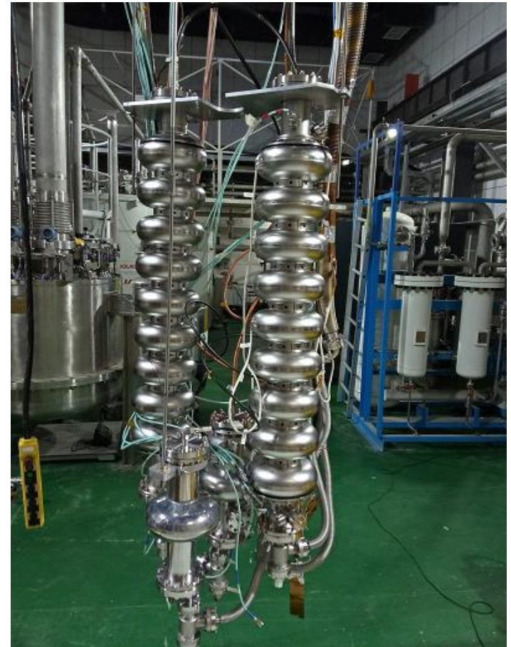
图3.16 高能所研制的1.3GHz 9 cell 超导高频腔
